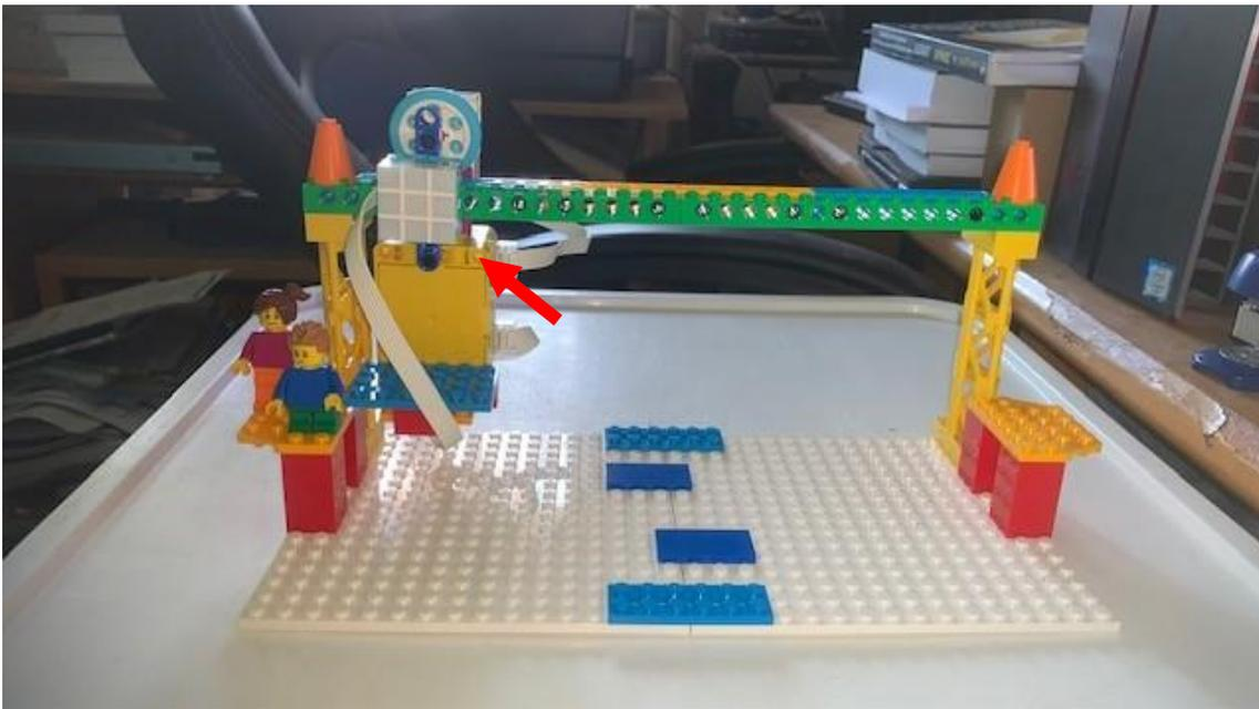
El sensor de luz se tiene que iluminar una luz de la parte derecha o izquierda según el sentido del teleférico.
